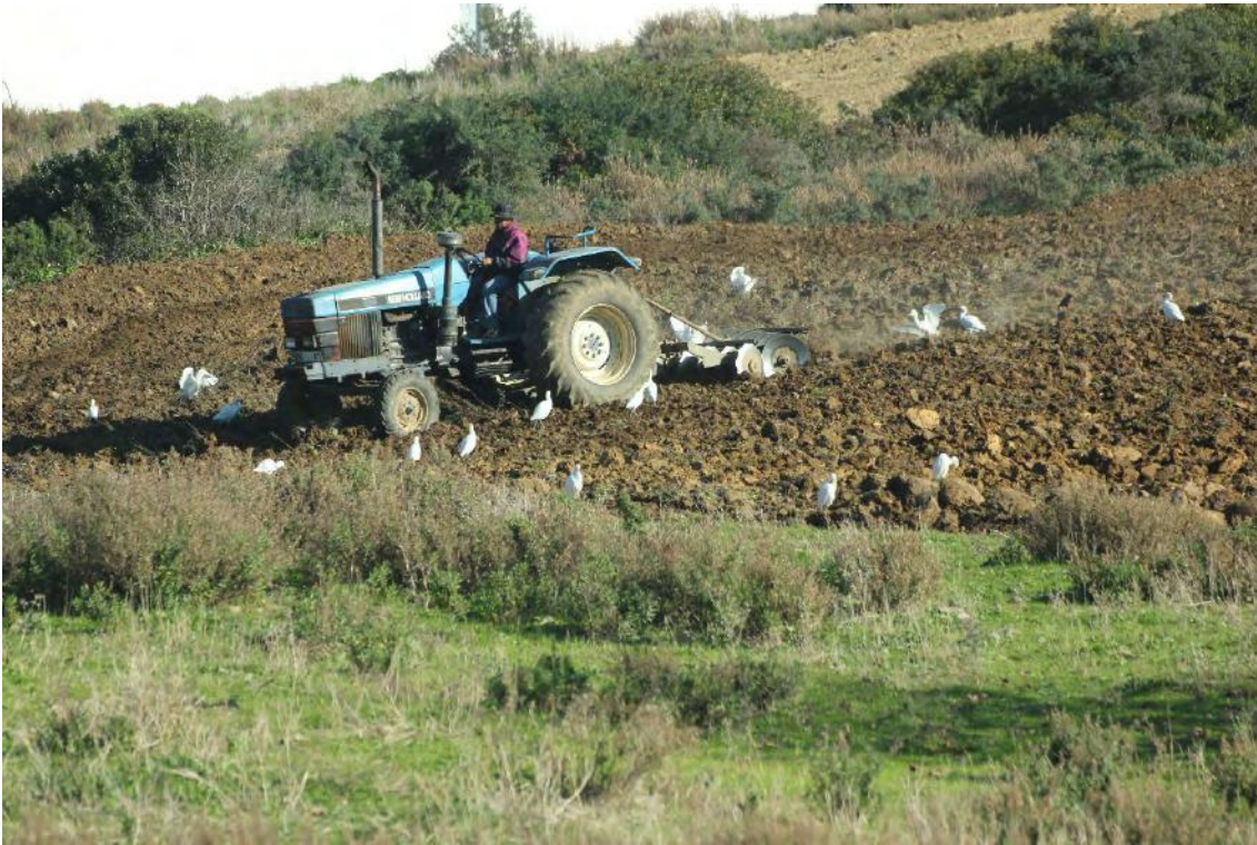
Imagen 8. La tracción mecánica es la principal consumidora de energía en los secanos mediterráneos. Laboreo con grada de disco en Marruecos.
